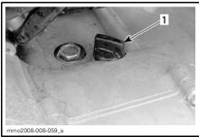
FILL PLUG — LH SIDE OF ENGINE 1. Gearbox fill plug
